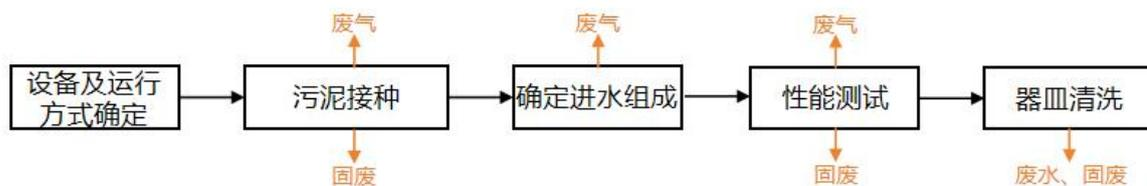
图 2-4 污泥接种实验流程图
