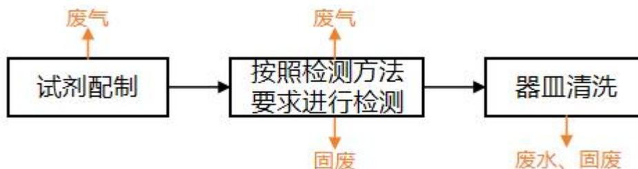
图 2-5 检测类实验流程图
